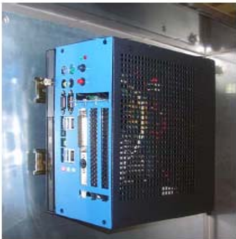
DIN Rail Mounting
