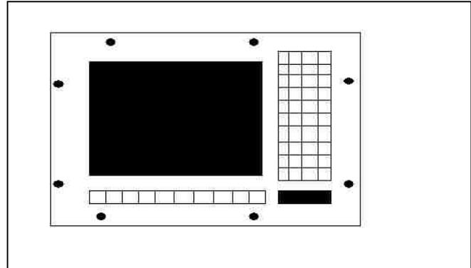
**TFT Monitor für Pult- oder Panel-Montage mit kundenspezifischer Platte. Befestigung von hinten mit Stehbolzen
