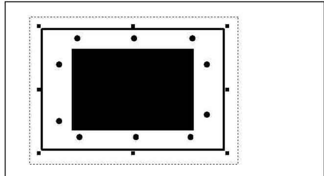
**TFT Monitor für Pult- oder Panel-Montage mit kundenspezifischer Platte. Befestigung von hinten mit Stehbolzen
